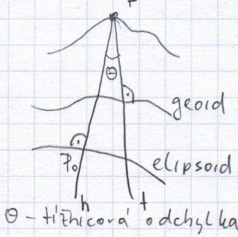
1, korekce  $\sigma_1$  z rozdílu třínice a normály elipsoidu
